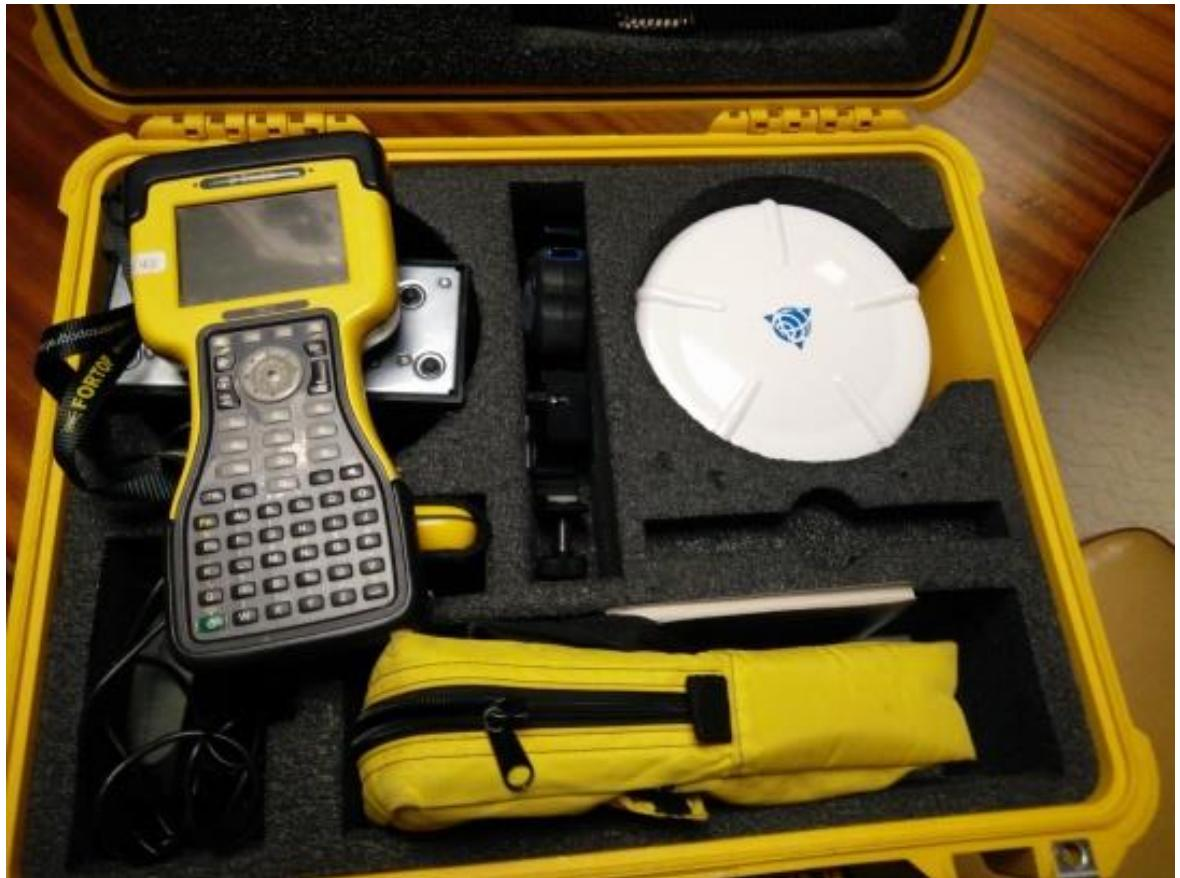
**Figura 1.** Receptor Trimble 5800 GPS do CFEA de Guísamo.
